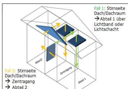
Licht, das über den Dachraum aus lichtdurchlässigen Giebelfronten oder aus Lichtbändern im Dach in den Zentralgang und von dort in das Abteil geht, wird berücksichtigt.
