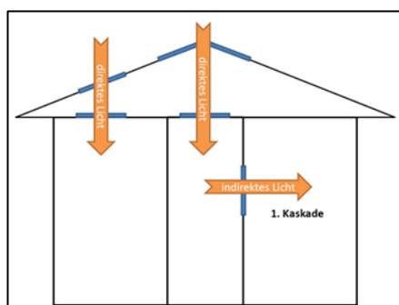
Wenn der direkte Lichteinfall von oben über eine Lichtplatte ermöglicht wird, kann das Licht für die darunterliegenden Räume als direkter Lichteinfall berücksichtigt werden. In diesem Fall ist auch die Weiterleitung als indirektes Licht über den Zentralgang möglich.
