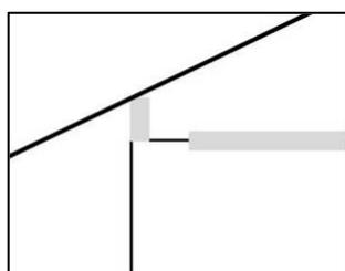
In diesem Beispiel kann das durch das Lichtband einfallende Licht als indirektes Licht für die in erster Kaskade angrenzenden Abteile angerechnet werden. Eine Weiterleitung über den Zentralgang und dann in die Abteile ist nicht möglich.
