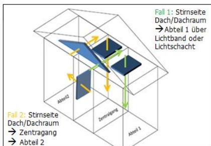
Licht, das über den Dachraum aus lichtdurchlässigen Giebelfronten oder aus Lichtbändern im Dach in den Zentralgang und von dort in das Abteil geht, wird berücksichtigt. Beide Fälle in der nebenstehenden Grafik können für das Kriterium Tageslicht angerechnet werden. Dabei gilt: In Fall 1 kann das Licht als direktes Licht angerechnet werden, in Fall 2 ist die 1. Kaskade erreicht.
